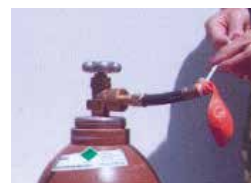
4 Schnellverschluss und Ballon über das Ballongasventil ziehen
