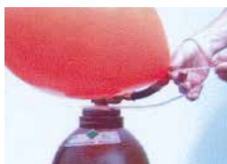
6 Ballon mit Hilfe des Schnellverschlusses verschließen
