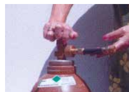
7 Handrad vom Flaschen-Absperrventil schließen
