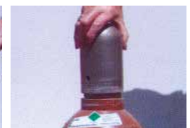
10 Flaschenkappe wieder aufschrauben
